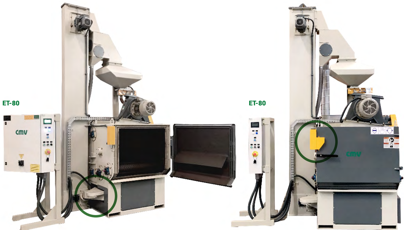
ET-80 Tamiz vibratoria para clasificación abrasiva
