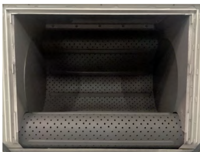
ET-80 vista interna de la cámara de granallado
